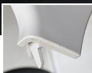
PŘED ČIŠTĚNÍM: díly znečištěné zbytky ve formě
