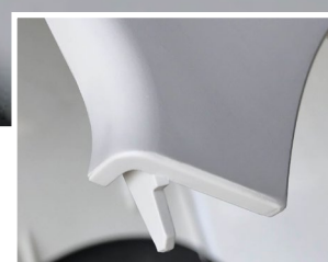
PO ČIŠTĚNÍ: díly po čištění formy přípravkem Lusin® MC1718
